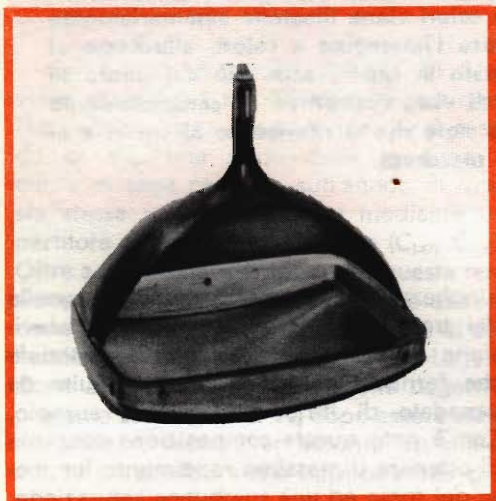
Fig. 2 - Ampolla sezionata. È stata tolta la maschera forata. Si vedono due dei « chiodi » di fissaggio della maschera. Sul bordo esterno dello schermo si possono vedere i punti di riferimento schermo-cono.
